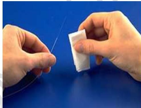
5. Realizar los respectivos cortes a la fibra con el alicate de corte, se pueden realizar diferentes medidas de corte dependiendo de la necesidad del empalme.
