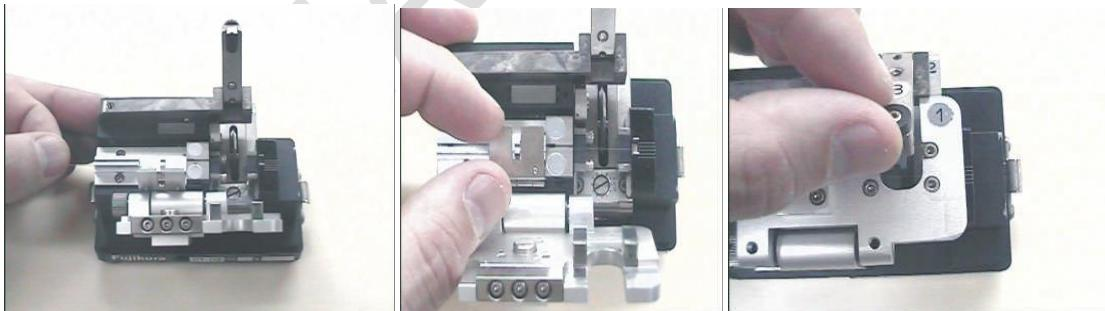
6. Destapar la tapa de protección y Colocar las fibras en los extremos de la maquina, Instalándolas cerca a los electrodos. Cerrar la tapa de protección.
